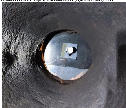
Рис. 2. Заряд ВВ, размещенный в мортривзрывной камеры
