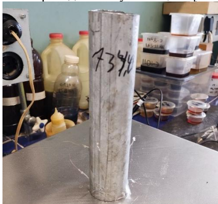
Рис. 1. Заряд ВВ, помещенный в стальную трубу
